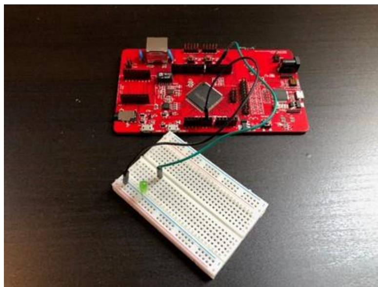
資料來源：本計畫彙整 圖 27、M487 與 LED 接線組裝
