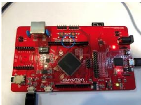
圖 16、Python 範例程式，開發板的 LED 熄滅
